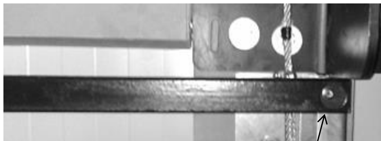
Zajištění rozpěry do kolejnice šrouby Tex 6,3 nebo M8
